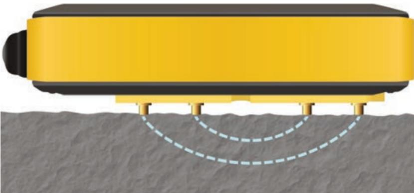
**REMARQUE:** Il est suggéré à l'opérateur de la Mètre de prendre 3 à 4 mesures à proximité les unes des autres, en notant la valeur de mesure maximale pour cette zone d'inspection. L'utilisation du mode **Hold Max** (p. 3) rend ce processus rapide et pratique.
