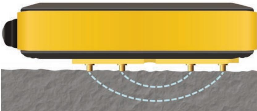
**HINWEIS:** Wir empfehlen, 3-4 Messungen in unmittelbarer Folge durchzuführen und dabei den maximalen Messwert für den jeweiligen Prüfbereich zu notieren. Die Verwendung des **Hold Max-Modus** (S. 3) vereinfacht und beschleunigt diesen Vorgang.
