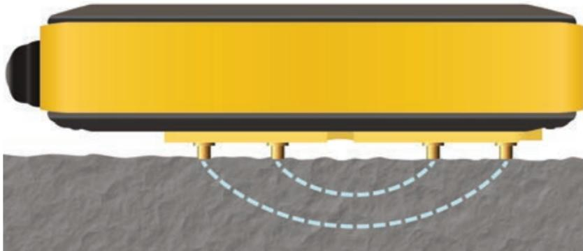
**NOTA:** Se sugiere que el operador de Medidor tome de 3 a 4 mediciones en proximidad cercana una de la otra dentro del área inspeccionada. El valor máximo será el valor de medición. Puede utilizar el modo **Retención Max** ("Hold Max", pág. 3) para hacer este proceso rápido y convenientemente.
